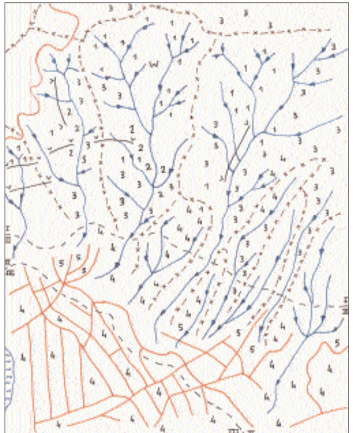
A la derecha: Interpretación de fotografías aéreas de una cuenca de drenaje (escala original 1:15000, reproducción reducida)
